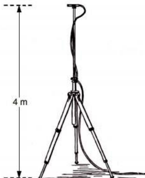
Figura 5-4 Ubicación del micrófono para medición de ruido ambiental
